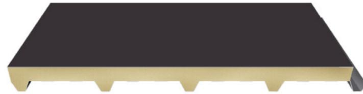
RAIN DECK è il pannello coibentato ideale per l'impermeabilizzazione, progettato per l'applicazione su coperture a falda piana o con inclinazione inferiore al 7% e disponibile in molteplici versioni per l'applicazione di guaine tradizionali e di guaine sintetiche a base poliolefinica.
