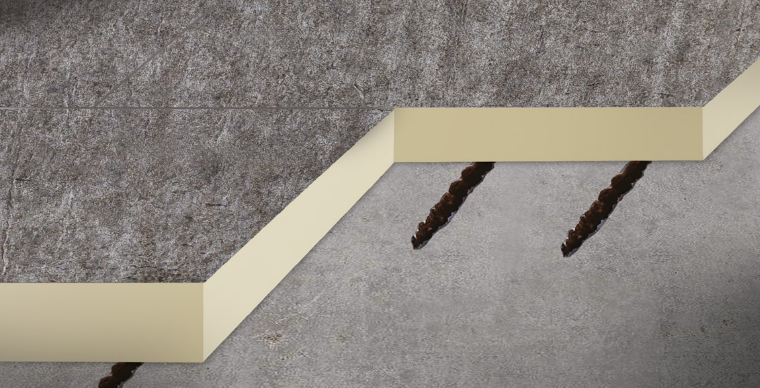
Adesione con collanti o schiuma poliuretanica / Bonding with adhesives or polyurethane foam
